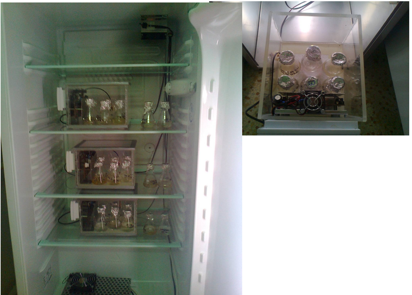
Obr. 8: Umístění experimentálních kultur v ledničce s termostaty, ty se nacházejí na průhledných boxech, které jsou uzavřené v průběhu experimentu, v lednici se udržuje termostatem teplota 10^\circ\text{C}
