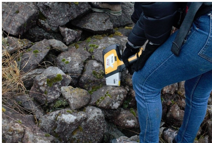
Obr. 7 Měření pomocí ručního XRF analyzátoru v NPR Křížky, 16. 11. 2021
